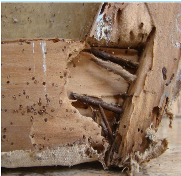
Detalhe do intenso ataque de insetos xilófagos no chassi Da pintura “São João e São Thiago” IMAGEM: Daniele Barbosa, nov 2012
